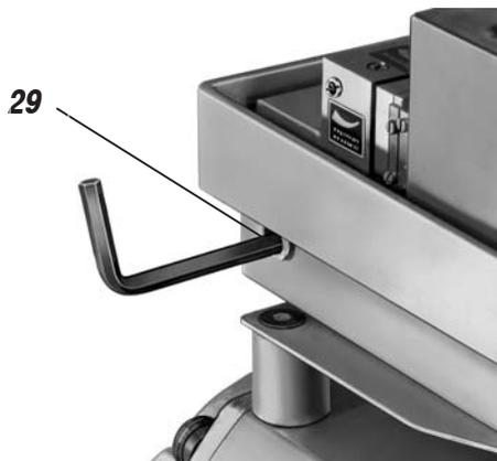
Abb. 24: Festschrauben des Anlenkhebels
