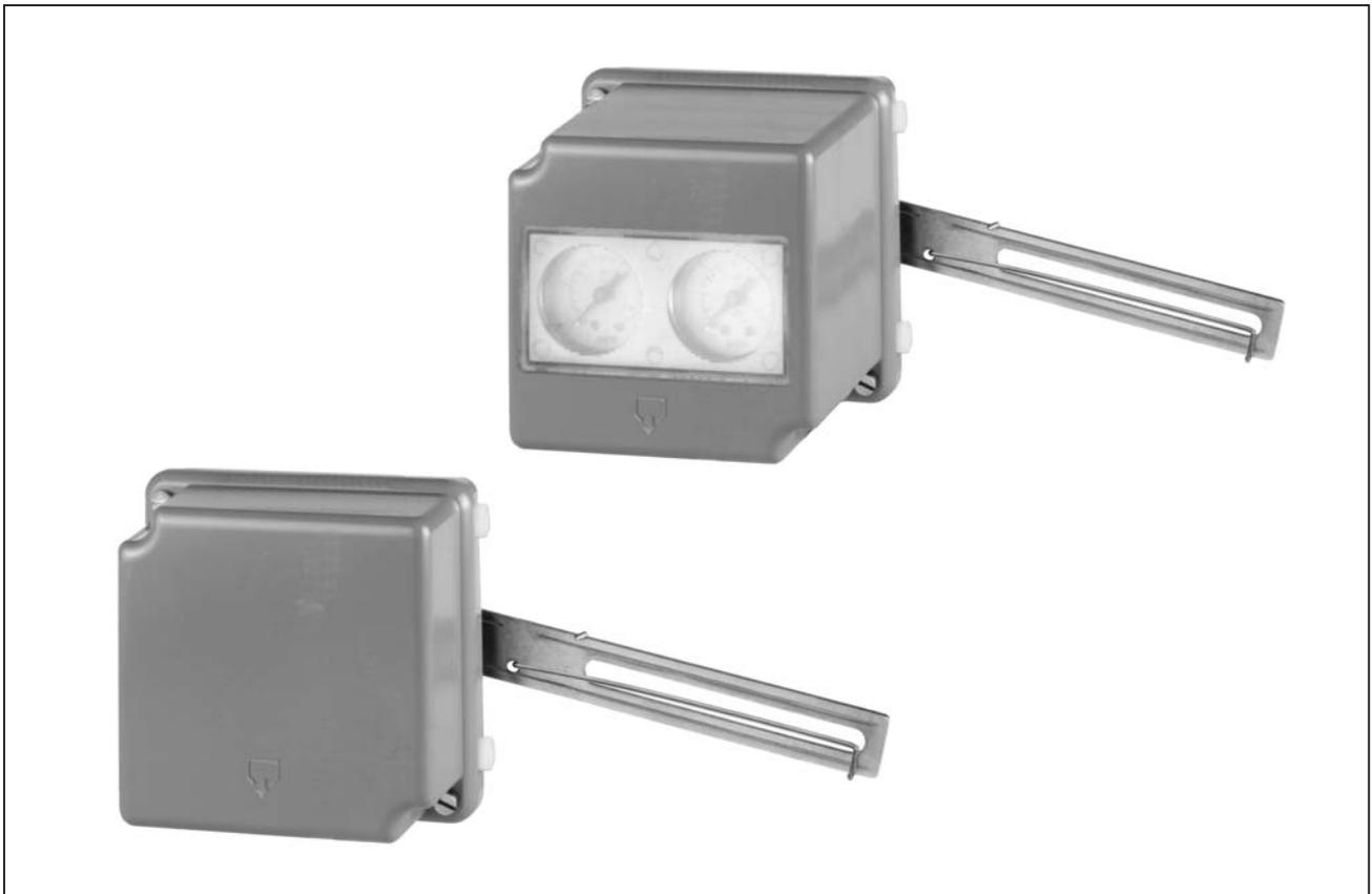
Der pneumatische Stellungsregler SRP981 dient zur Ansteuerung pneumatischer Stellantriebe mit pneumatischen Stellsignalen. Er wird angewendet zur Reduzierung von unerwünschten Einflüssen durch Ventilreibung, zur Erhöhung der Stellkraft und zur Verkürzung der Stellzeit.
