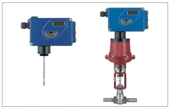
Diese Version wurde entwickelt für Direktmontage auf dem Kopf kleiner Antriebe ohne Laterne - die Lösung für Antriebe mit bis zu 50 mm Hub. An Stelle des üblichen Drehpotentiometers wird hier ein Linearpotentiometer als Stellungsrückmeldung eingesetzt.
