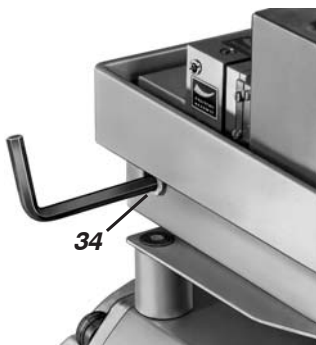
Abb. 19: Festschrauben des Anlenkhebels
