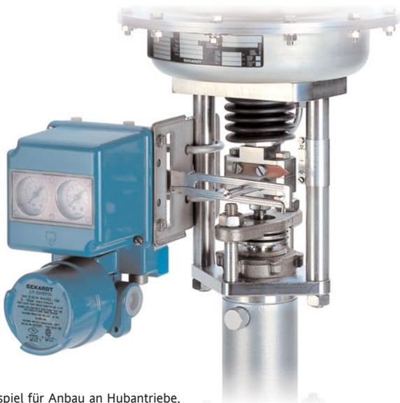
Beispiel für Anbau an Hubantriebe, Version mit integrierten Manometern.
