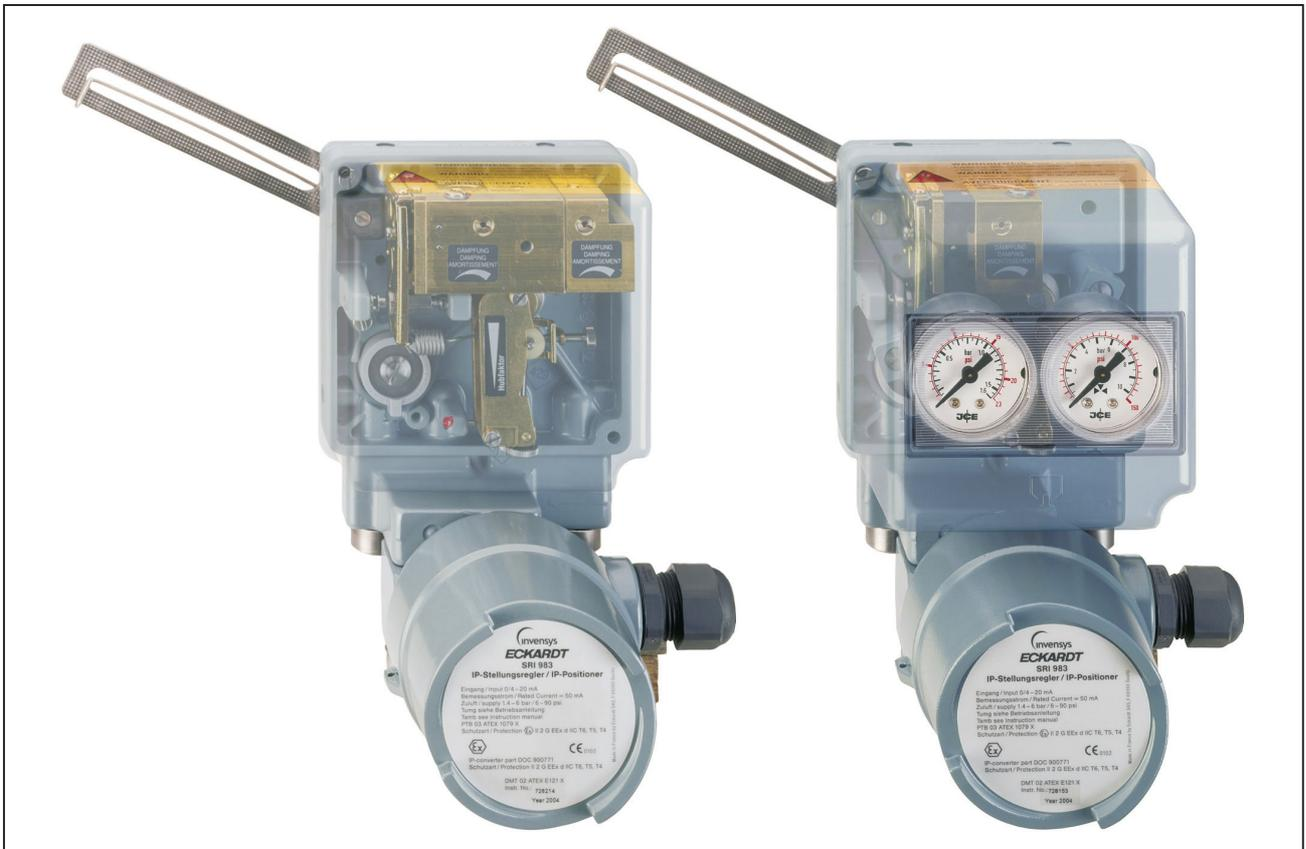
Der elektro-pneumatische Stellungsregler SRI983 dient zur Ansteuerung pneumatischer Stellantriebe mit dem Stellsignal von Leitsystemen und elektrischen Reglern. Er wird angewendet zur Reduzierung von unerwünschten Einflüssen durch Ventilreibung, zur Erhöhung der Stellkraft und zur Verkürzung der Stellzeit.
