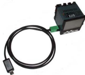
Er kann wie dargestellt durch das Gehäuse des Reglers angeschlossen werden (z. B. wenn dieser neu ist). Alternativ kann er auch direkt an die Platine angeschlossen werden, wenn der Regler aus seinem Gehäuse genommen wird (z. B. wenn dieser bereits mit dem Prozess verdrahtet wurde).
