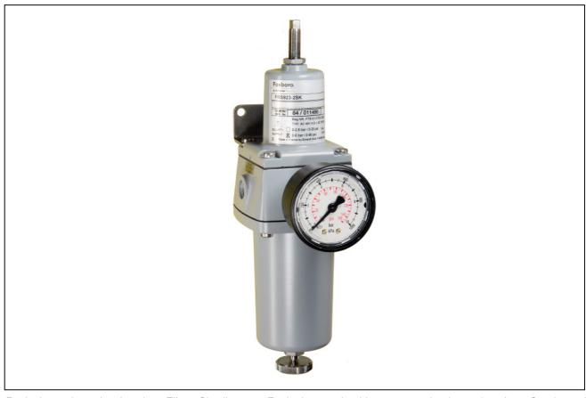
Reduzierstation mit oder ohne Filter. Sie dient zur Reduzierung des Versorgungsdrucks und entfernt Staub- und Wasseranteile. Druckminderer einschl. Befestigungswinkel, Filter mit Auffangschale.
