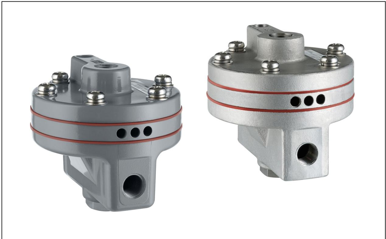
Die Luftleistungsverstärker der VBS100-Serie werden zwischen Stellungsregler und pneumatischem Stellantrieb angebaut. Sie verstärken den Volumenstrom des Stellungsreglers und werden empfohlen beim Betrieb größerer Stellantriebe zur Reduzierung der Stellzeit. Der **VBS100** ist verfügbar im Aluminium- und **VBS110** im Edelstahlgehäuse. Das eingebaute Bypass-Ventil dient zur Anpassung des dynamischen Verhaltens für einen stabilen Betrieb bei den verschiedensten Antriebsgrößen.
