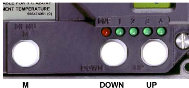
Falls mit den lokalen Drucktasten keine Bedienung am Gerät möglich ist (es erscheint Meldung 1, siehe S. 50), sollte geprüft werden, ob der Schreibschutz gesetzt ist! Ändern z.B. mit PC und FDT/DTM-Software.
