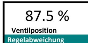
**MELDUNG:** Der SRD erkennt ein Ereignis, das der Anwender durch geeignete Maßnahmen (siehe Seite 50) beseitigen muss, um den Betrieb fortzusetzen. Das kann z.B. eine falsche Konfigurierung sein oder fehlende Zuluft.
