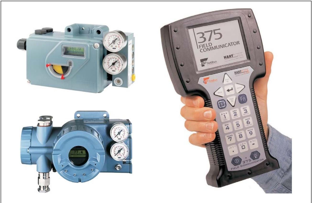
Die intelligenten elektro-pneumatischen Stellungsregler SRD991/SRD960 dienen zur Ansteuerung pneumatischer Stellantriebe. Sie können von Leitsystemen und elektrischen Reglern mit dem analogen Stellsignal 4 ... 20 mA, welchem wahlweise ein HART-Kommunikationssignal überlagert ist, betrieben werden. Alternativ ist der digitale Betrieb über HART oder FOXCOM möglich.
