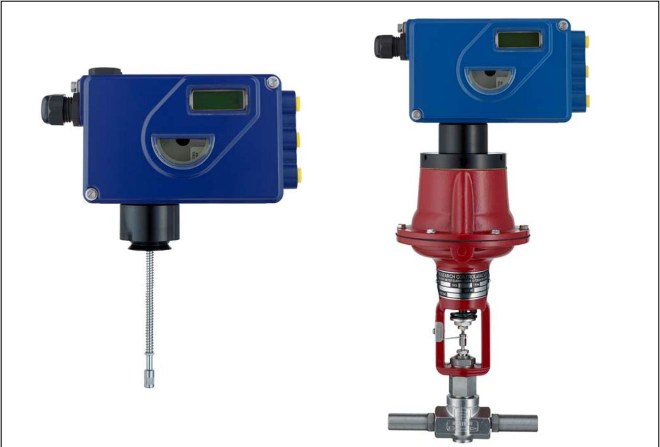
Diese Version wurde entwickelt für Direktmontage auf dem Kopf kleiner Antriebe ohne Laterne - die Lösung für Antriebe mit bis zu 50 mm Hub. An Stelle des üblichen Drehpotentiometers wird hier ein Linearpotentiometer als Stellungsrückmeldung eingesetzt.
