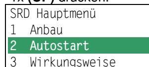
Durch gleichzeitiges Drücken der Tasten **(UP)+(DOWN)** kommt der SRD in das Menü zur Auswahl des gewünschten Autostarts:
