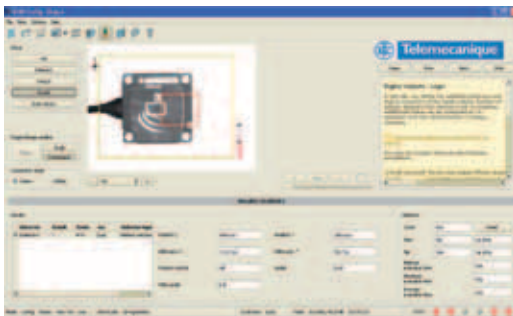
Schlechtes Teil: Markierung stimmt nicht überein
