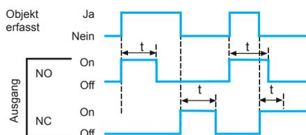
**Zeitverzögerung des Ausgangssignals**
