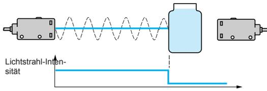
Der abgestrahlte Lichtstrahl hat eine Wellenlänge, die der maximalen Absorptionsfrequenz der Wassermoleküle entspricht.
