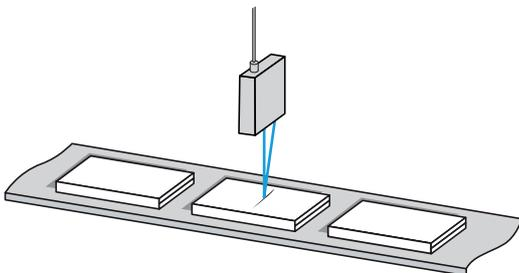
Kontrolle bei Bruch einer Werkzeugschneide an einem Presswerkzeug
