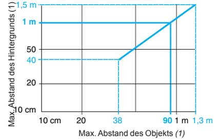
Bei Teach-in eines 1 m entfernten Hintergrunds ist die Erfassung eines Objekts im Abstand 0...90 cm möglich.
