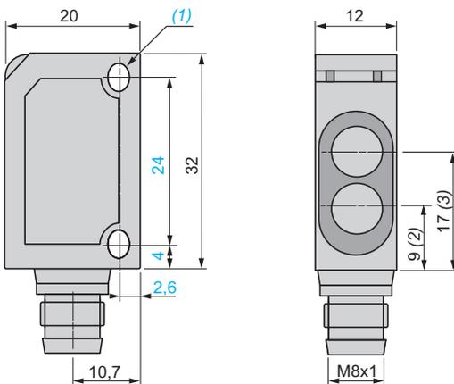
(1) 2 Langlochbohrungen  $\varnothing 3,2 \times 4,2$ .
