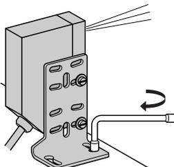
Für eine störungsfreie Erfassung ist eine sichere Befestigung notwendig.
