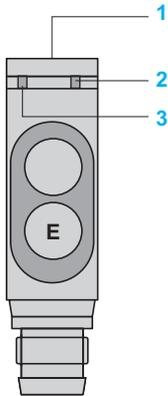
(1) Unabhängig davon, ob der Ausgang auf NO oder NC eingestellt ist, erlischt die LED „Erfassen“ nur bei Unterbrechung des Lichtstrahls.
