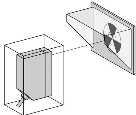
Bei Außenmontage bitte ein Schutzgehäuse mit Wärmedämmstoff zur Vermeidung von Reif und Kondensat auf der Optik vorsehen.
