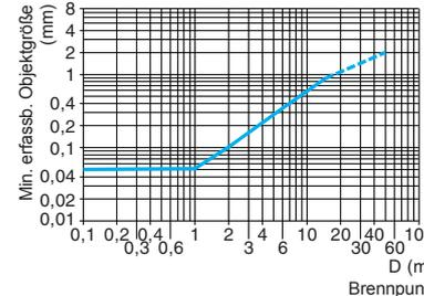
Durch Änderung des Brennpunktes können Objekte bis 0,2 mm erfasst werden. Befestigungsschrauben 1 lösen. Das Rändelrad 2 auf der Sensorfrontseite solange drehen, bis der Lichtstrahl auf den gewünschten Brennpunkt fokussiert ist. Nach der Einstellung Befestigungsschrauben 1 wieder anziehen.
