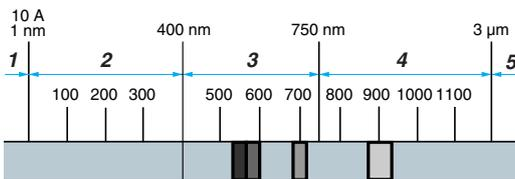
1 Röntgenstrahlen, 2 Ultraviolett, 3 Sichtbares Licht, 4 Nahes Infrarot, 5 Fernes Infrarot
