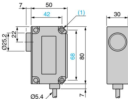
(1) 2 Bohrungen für Schraube M5, Tiefe 10 mm
