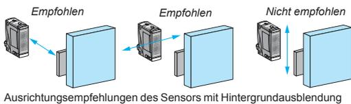
Ausrichtungsempfehlungen des Sensors mit Hintergrundausbuchtung
