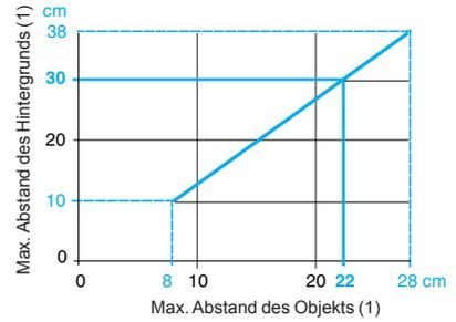
Beispiel: Bei Teach-in eines 30 cm entfernten Hintergrunds ist die Erfassung eines Objekts im Abstand 0...22 cm möglich.
