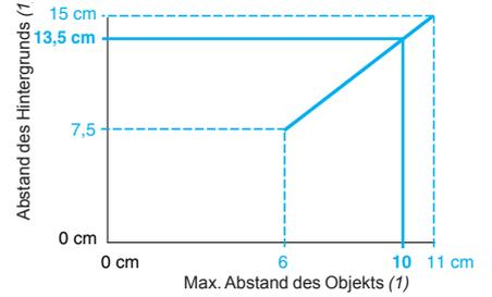
Beispiel: Bei Teach-in eines 13,5 cm entfernten Hintergrunds ist die Erfassung eines Objekts im Abstand 0...10 cm möglich.
