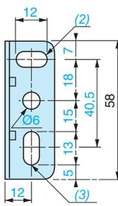
(2) 1 Langlochbohrung  $\varnothing 6 \times 12$
