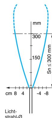
(1) Der Schaltabstand der Lichtleiter ohne Endhülsen kann durch den Einsatz einer Befestigung mit integrierter Optik XUF Z03, Z04 oder Z05 erhöht werden (siehe Seite 125).
