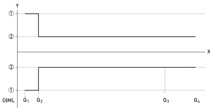
Figura 2-1: Velocidades de caudal ISO añadidas a la figura para una comparación con OIML
