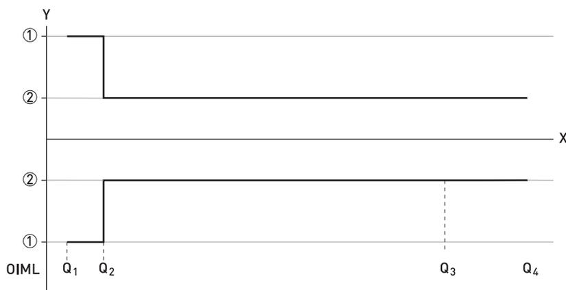
Figure 8-2: Débits ISO ajoutés au schéma pour comparaison avec OIML
